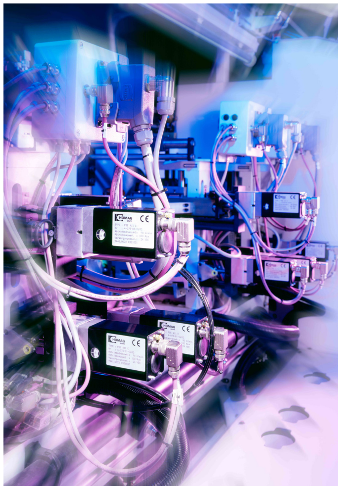
Abb. 3: Moderne Positioniersysteme an einer Holzbearbeitungsmaschine
