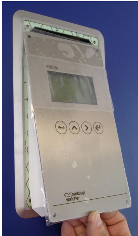
Bild 9: PUC 24 schräg von unten ansetzen
